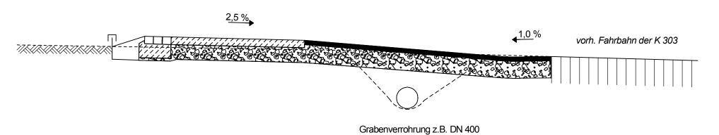
3 r. Pflasterstreifen 16/24/14 cm auf 20 cm Unterbeton (C 20/25) mit einseitiger Rückenstütze Bauweisen für Rad- und Gehwege gem. RStO 12 Tafel 6, Zeile 2, Beton
