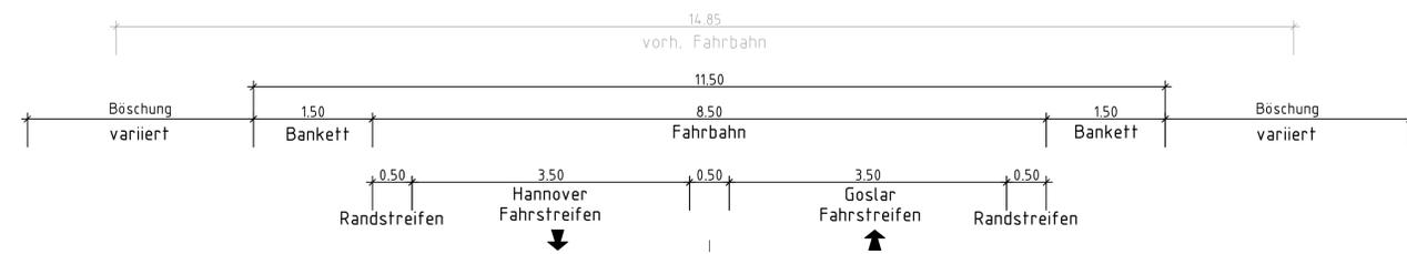
Schutzeinrichtung gem. RPS09, H1, W3
