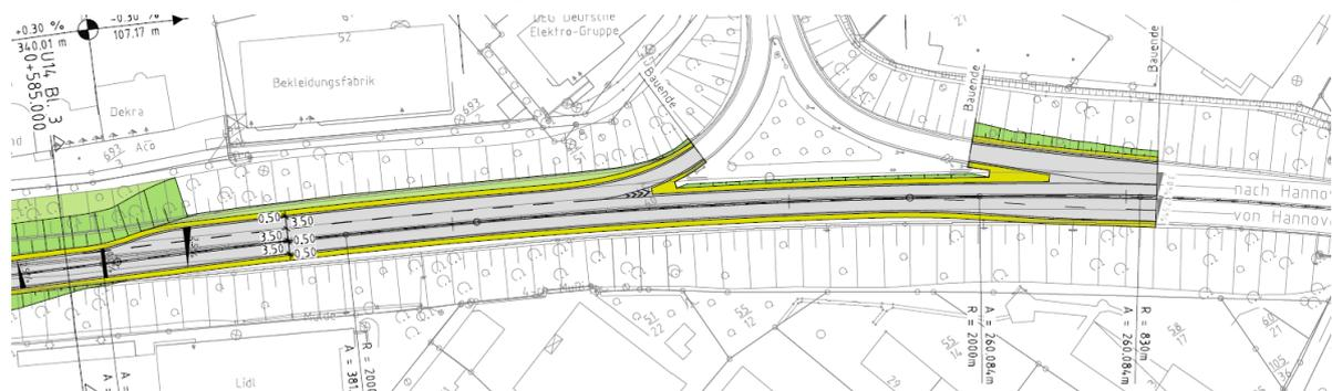
Abbildung 5: Variante 6, Entfall Fahrstreifen Richtung Hannover
