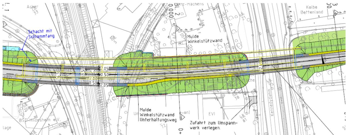
Abbildung 3: Variante 6, Detail Dammbauwerk / Brückenbauwerke
